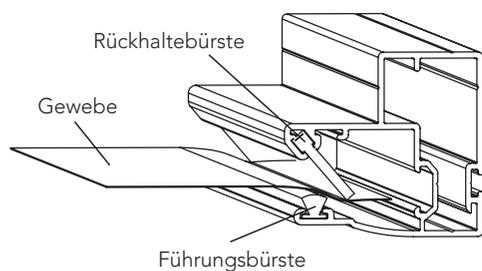
Sie können sich auch für etwas ganz besonderes entscheiden: das praktische Kombinationsrollo für Dachflächenfenster. Hier sind Insektenschutz- und Sonnenschutzgewebe seitlich in denselben Führungsschienen integriert und über Magnete in den Griffleisten verbunden. Wieviel Insekten- und Sonnenschutz Sie an welchem Tag, in welchem Augenblick haben wollen, das entscheiden Sie.
